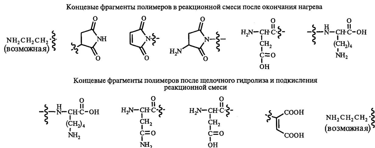
Рис. 3. Концевые группы полимеров, определенные при расшифровке масс-спектров образцов
